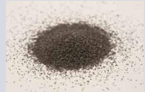
Les granulats (ou de sable fin) projetés jouent également un rôle d'anti-adhérent entre l'enduit et la matrice ou entre l'enduit et la boucharde facilitant la réalisation des décors.
